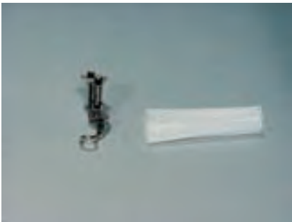
Stickfuss Nr. 15 Netz für gleichmässigen Fadenablauf (über Oberfadenspule stülpen)
