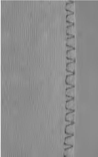
Der Overlockfuss Nr. 2A ist ein für Overlockstiche speziell entwickelter Fuss. Durch den Steg dieses Fusses wird genügend Faden in den Stich gearbeitet und somit die Elastizität des Stiches gewährleistet.
