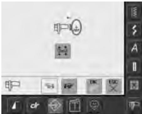
Die Rahmenjustierung ist die Abstimmung der Nadel zur Mitte des Rahmens. Die Justierung kann nur bei angeschlossenem Stickmodul und montiertem ovalen Stickrahmen ausgeführt werden. Sie muss nur einmal erfolgen, da sie für alle Stickrahmengrößen gleichermaßen gilt.
