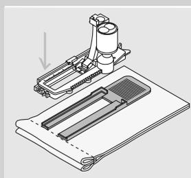
Muss ein Knopfloch quer zur Nähgutkante genäht werden empfiehlt es sich, eine Ausgleichplatte (als Sonderzubehör erhältlich) zu verwenden. Die Ausgleichplatte von hinten zwischen Nähgut und Schlittenfusssohle, bis zur verdickten Nähgutstelle einlegen und nach vorne schieben.
