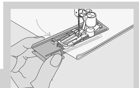
Zum Nähen eines Knopflochs in schwierigen Stoffen empfiehlt es sich die Transporthilfe (in einigen Ländern nur als Sonderzubehör erhältlich) zu verwenden. Sie kann nur zusammen mit dem Knopflochschlittenfuss Nr. 3A verwendet werden.
